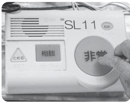
高齢者世帯に設置されている 緊急通報システム
