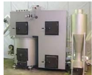
ペレットボイラー
