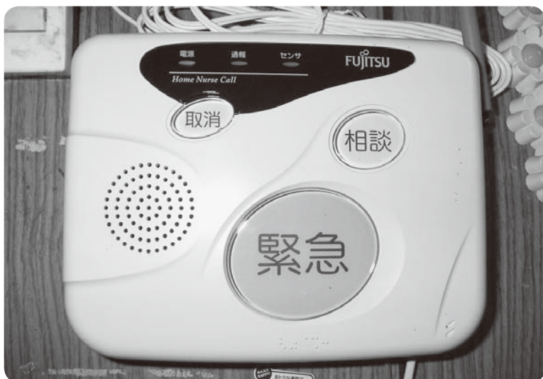
高齢者宅・緊急通報装置
