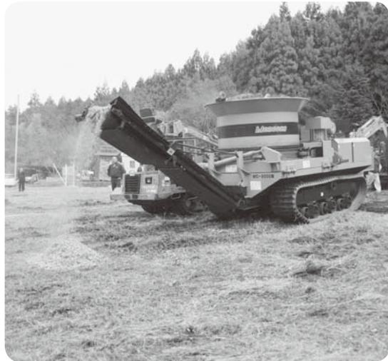
移動式破砕機によるチップ生産
